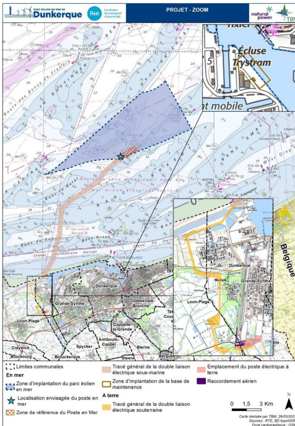
Figure 1: Localisation du parc éolien et tracé du raccordement électrique en mer et à terre (Source : dossier)
